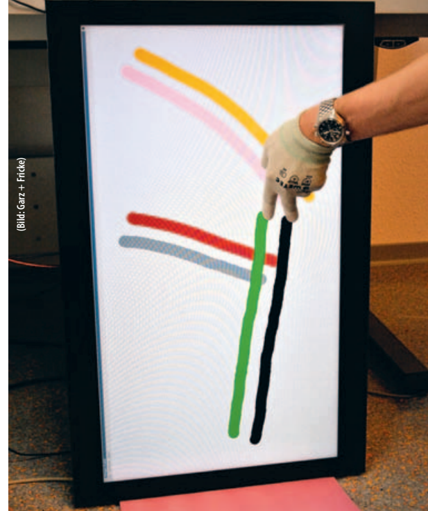
Bild 1. Durch gezielte Programmierung kann ein ein Touchscreen auf bestimmte Handschuhtypen optimiert werden.
