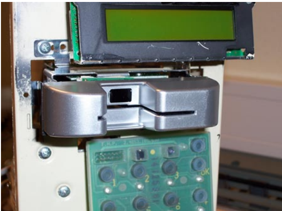
Eingebautes Mundstück mit integrierter IrDA-Schnittstelle
