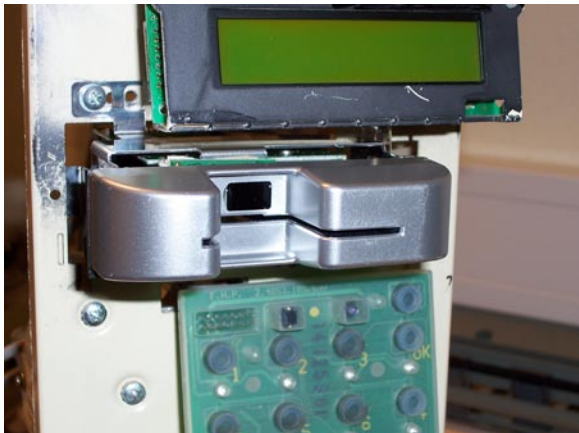
Eingebautes Mundstück mit integrierter IrDA-Schnittstelle
